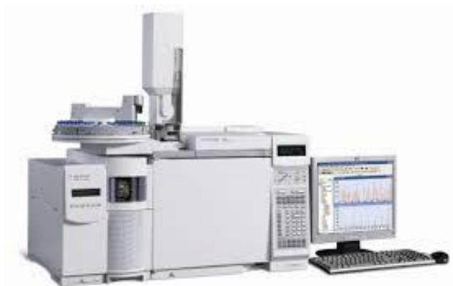
Gambar 2.8. Seperangkat alat GCMS
